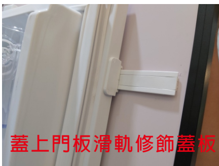
連結器與門板滑軌用螺絲鎖在冰箱門側邊
