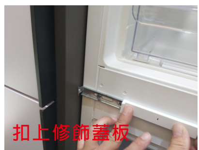
鎖上固定冰箱與側板用的連結五金
